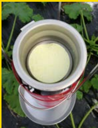
Vista de la pastilla antes de conectarse el evaporador
